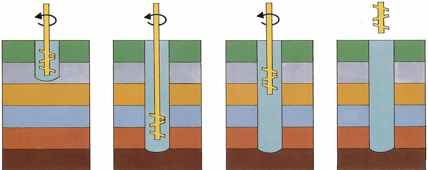
①攪拌ビットを回転させ、地盤をゆっくり掘り下げながら硬化剤を注入、土と混ぜ合わせる。(均一混合)
